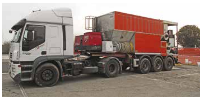
4. Il mescolatore su camion messo a disposizione da Deltapav
